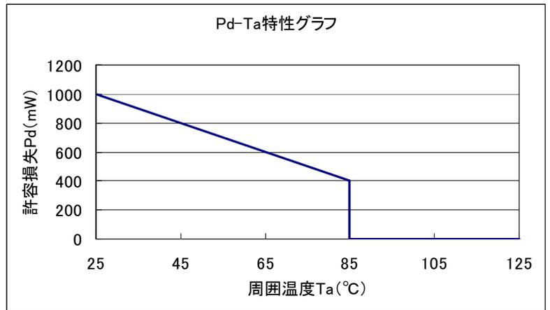
基板実装(  $T_{jmax}=125^{\circ}\text{C}$  )
