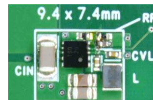
60V 300mA DC/DC : XC9702 世界最小クラスのソリューションサイズ 9.4mm x 7.4mm = 69.6mm 2
