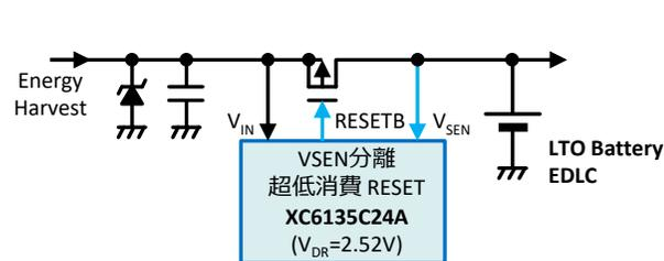
Supercap (EDLC) の場合、充電電圧/検出電圧 を適切に選択のこと。
